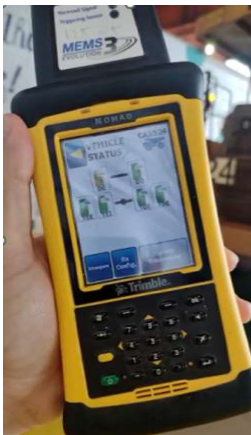
Figura 12- Dispositivo de avaliação de pressão de pneu em campo (PDA)
