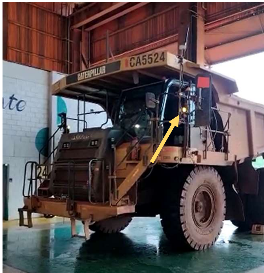
Figura 11- Registro após a montagem do sinaleiro no caminhão CA5524
