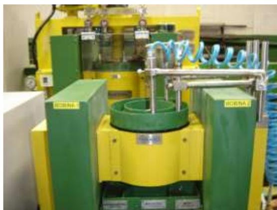
Figura 1: Concentrador eletromagnético Micromag.
