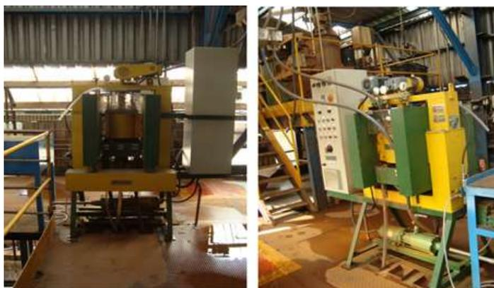
Figura 2: Concentrador eletromagnético Minimag
