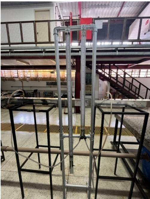
Figura 11 – Manômetro de coluna.
