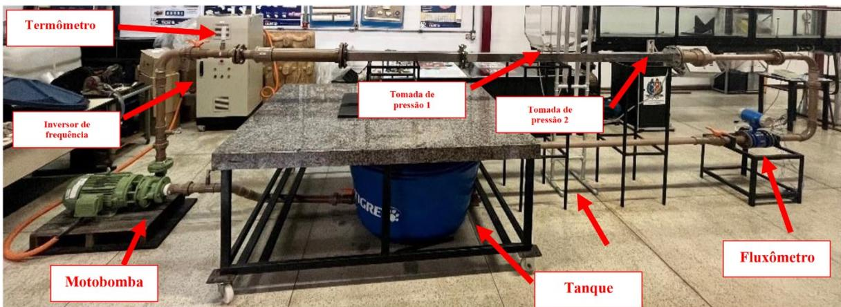
Figura 9 – Visão frontal anotada da Bancada de Fluxo do LAESS.
