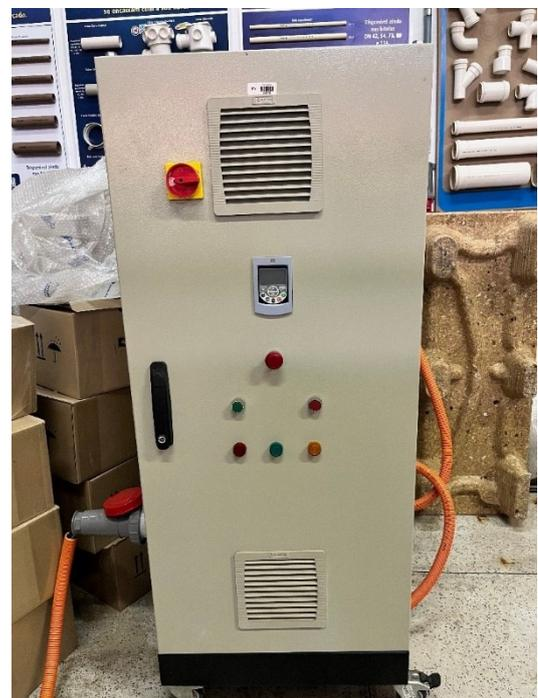
Figura 7 – Gabinete do inversor de frequência WEG CFW500 (não visível, dentro do gabinete).
