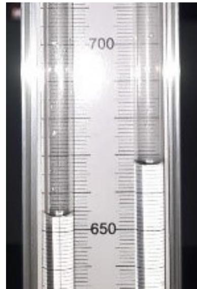
Figura 12 – Detalhe do manômetro de coluna, indicando uma variação de pressão de 14mmca.
