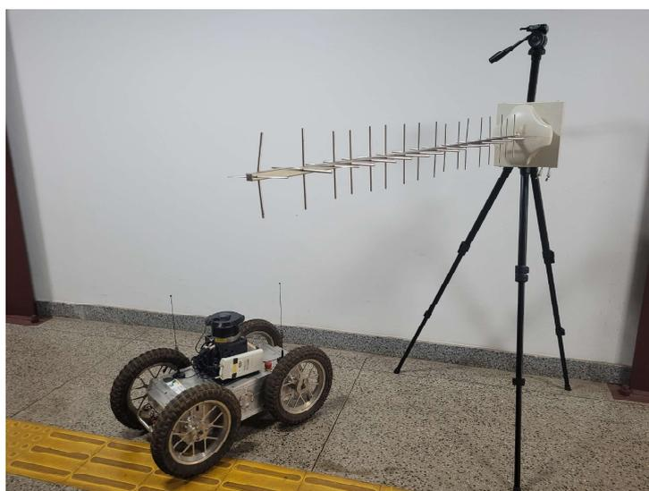
Figura 5.1: EspeleoRobô equipado com antenas omnidirecionais e antena direcional utilizada na base. Fonte: O autor.
