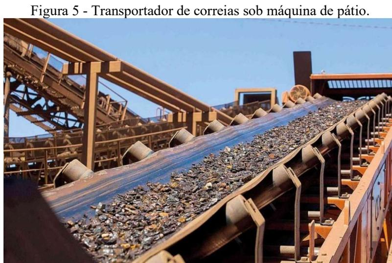
Figura 5 - Transportador de correias sob máquina de pátio.
