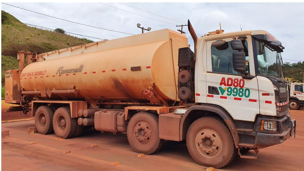
Figura 1.2: Comboio de 30.000 litros adaptado para abastecimento de equipamentos em campo.
