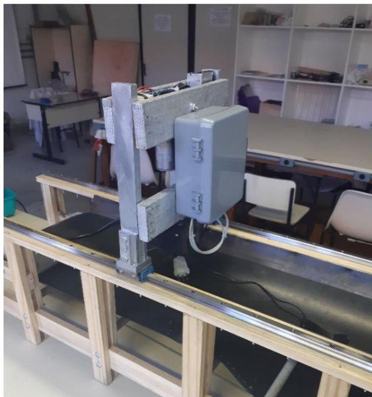
Figura 3.11: Sistema de medição de umidade de minério de ferro acoplado ao transportador de correia.
