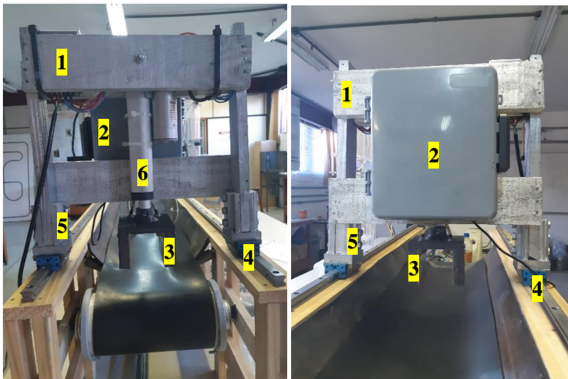
Figura 3.10: Sistema de medição de umidade de minério de ferro acoplado a correia transportadora.
