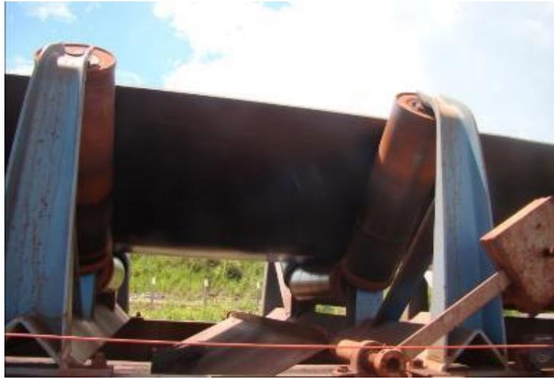
Figura 6: Detetora de rasgo de correia.
