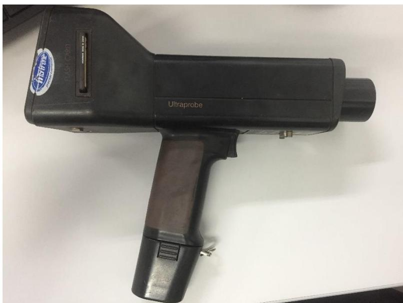
Figura 14: Sensor ultrassônico Ultraprobe 10000 (UE Systems Inc.).
