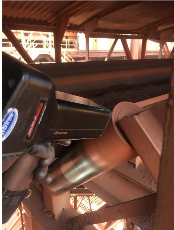
Figura 15: Gravação de ultrassom de um rolo em um transportador do TMPM.
