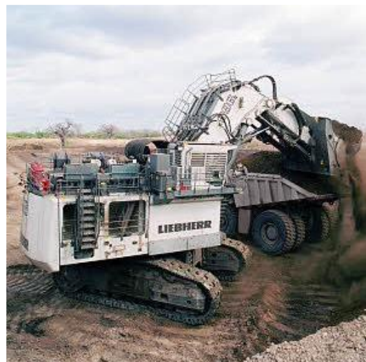
Figura 1 - Escavadeira Shovel Hidráulica
