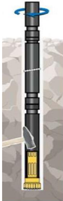
Figura 3: Método de perfuração rotopercussiva DTH
