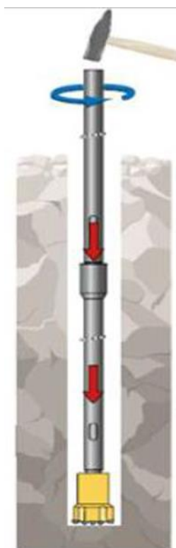
Figura 4: Método de perfuração rotopercussiva - Top Hammer
