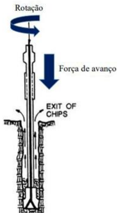
Figura 2: Método de perfuração rotativa com broca tricônica
