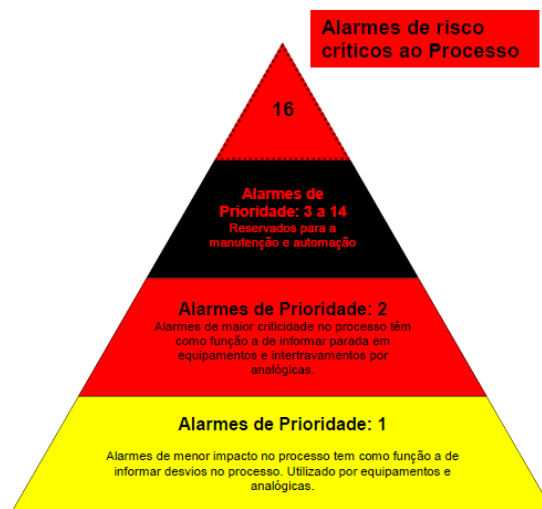
Figura 7 – Prioridade dos alarmes no sistema Supervisão WinCC v7.4 Siemens.
