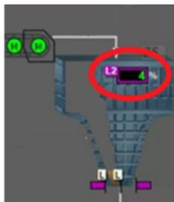
Figura 1.4: Detalhamento da indicação de nível dos silos.
