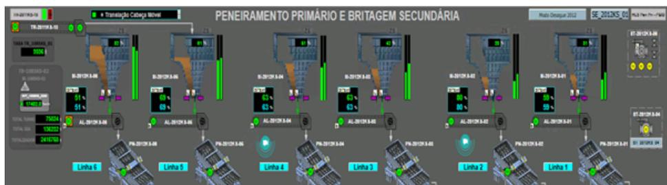
Figura 3.4: Correia transportadora móvel (TR-2011KS-10) posicionada no silo de número 6 (SI-2012KS-06).
