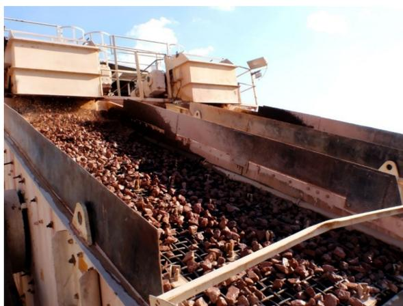
Figura 3.9: Peneira Vibratória Inclinada.
