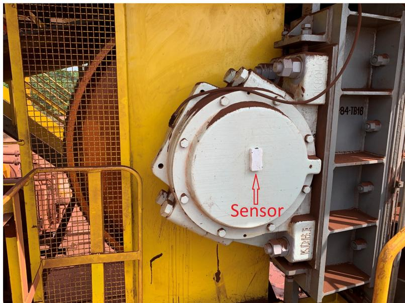
Figura 4.2: Sensor Datalogger acoplado a um mancal.
