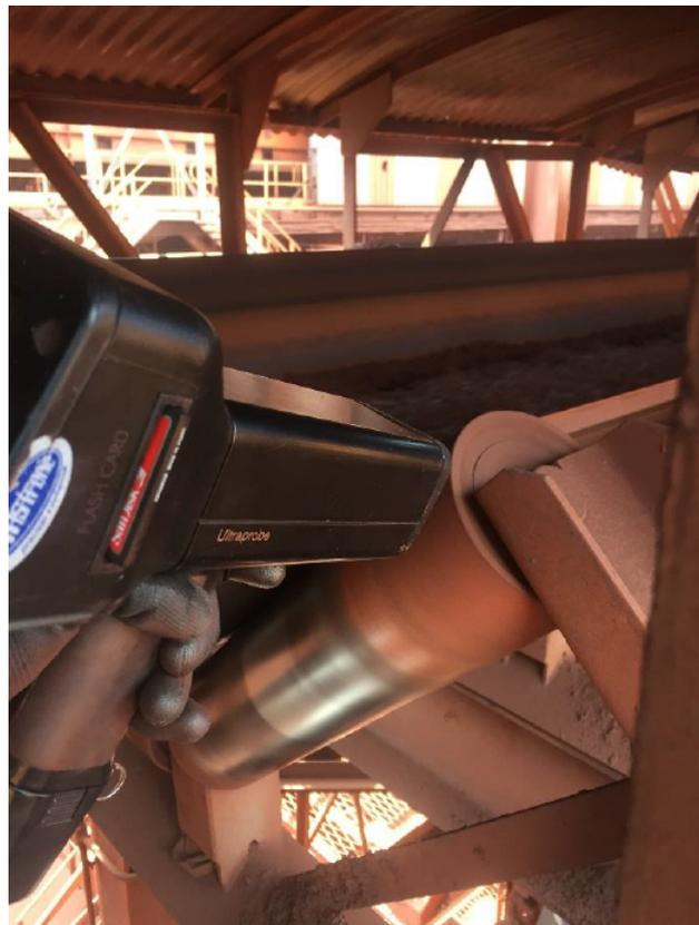
Figura 1.10: Medição ultrassônica em um rolo de um TR.
