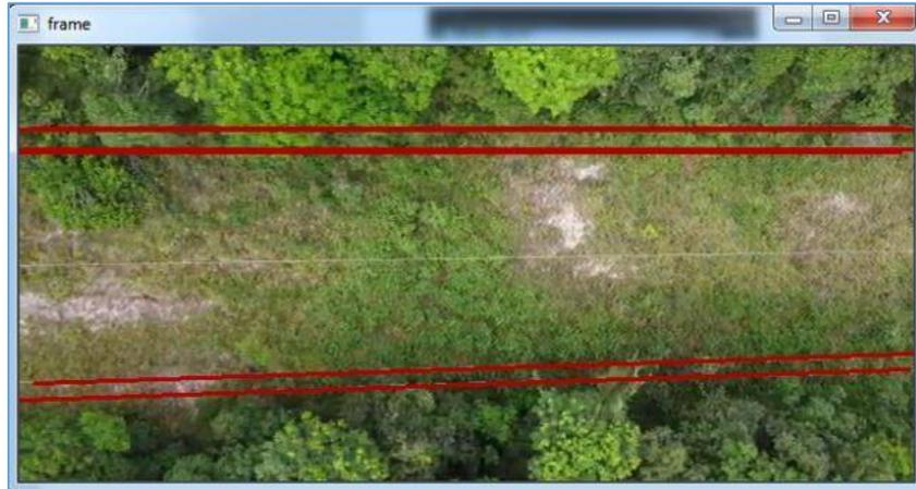
Figura 6.18: Segmentação da faixa de servidão com corte de um vídeo da LT.
