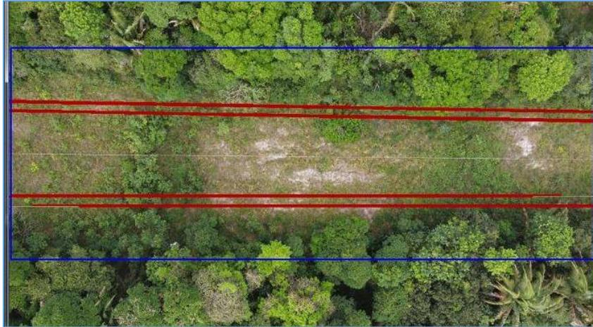
Figura 6.10: Segmentação da faixa de servidão destacada em azul.
