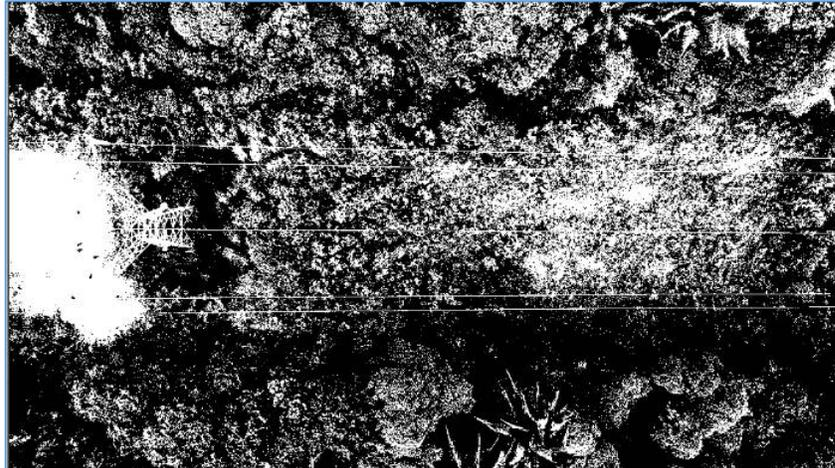
Figura 6.35: Limiarização pelo método de Otsu, com limiar em 75.
