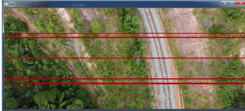
Figura 6.14: Segmentação da faixa de servidão com corte da imagem original.
