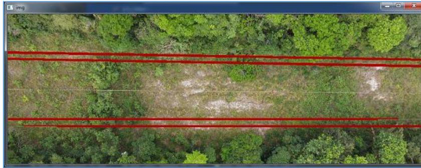
Figura 6.12: Segmentação da faixa de servidão com corte da imagem original.
