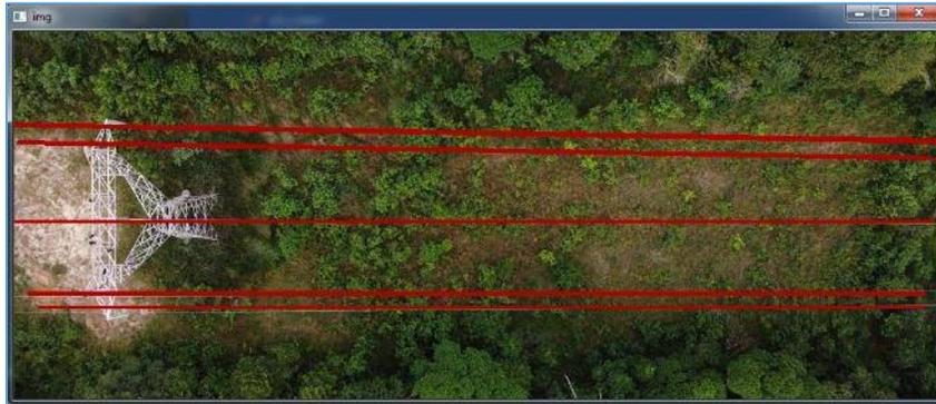
Figura 6.16: Segmentação da faixa de servidão com corte da imagem original.
