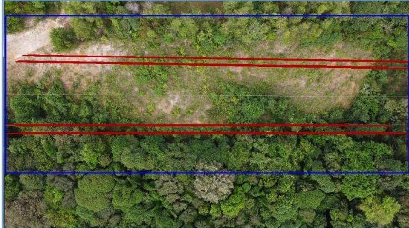
Figura 6.8: Segmentação da faixa de servidão destacada em azul.
