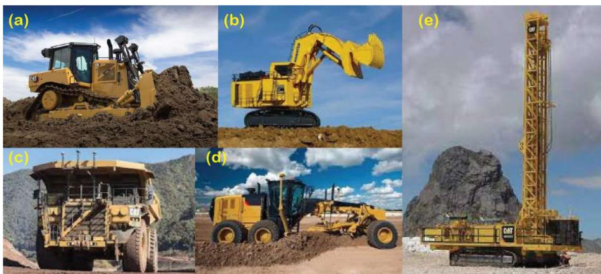
Figura 1.1: Equipamentos autônomos que podem ser encontrados na mineração: (a) trator, (b) escavadeira, (c) caminhão, (d) motoniveladora e (e) perfuratriz.
