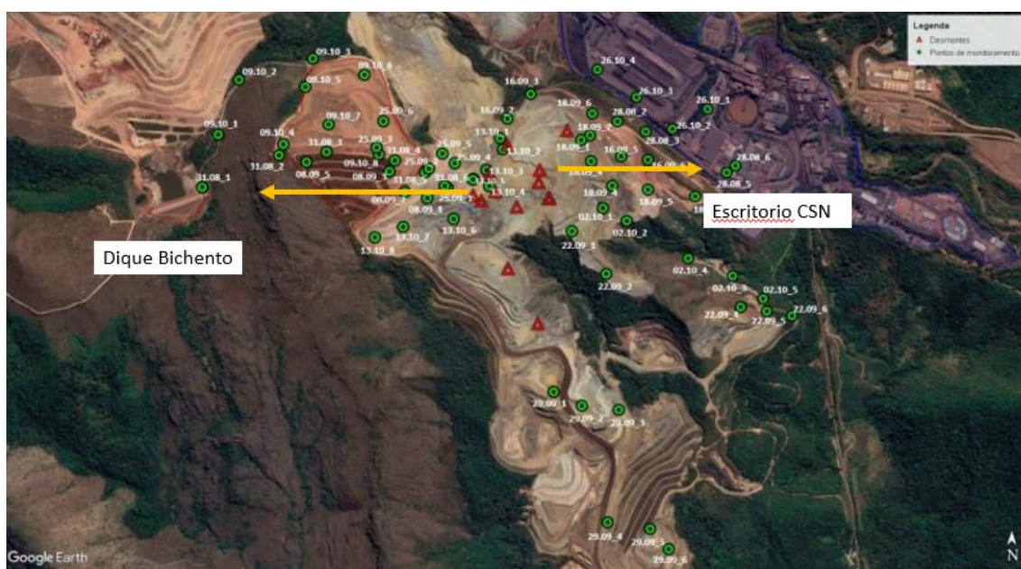
Figura 12 - Alocação de sismógrafos (em verde) e detonações monitoradas (em vermelho).
