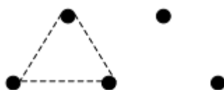
Figura 1- Malha de perfuração estagiada
