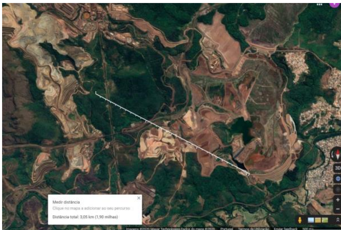
Figura 15 - Distância entre o limite da cava da mina de Viga e o Barramento.
