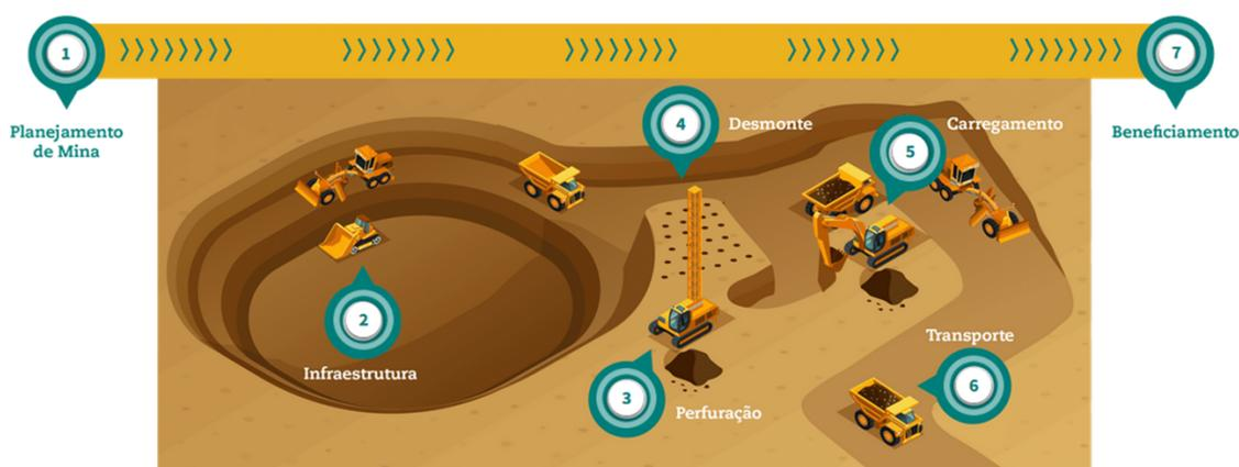
Figura 1.1: Interações entre processos e equipamentos predecessores à etapa de beneficiamento. A falta de equipamento de carga ocorre pela interação do processo de Transporte (6) e Carregamento (7) apresentado acima
