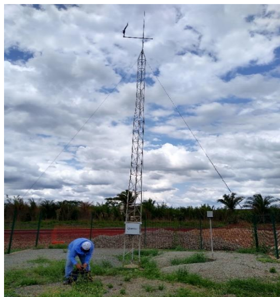
Figura 1 - Imagens da estação meteorológica automática do Instituto Tecnológico Vale (ITV), localizada próxima ao terminal ferroviário de Arari (MA).
