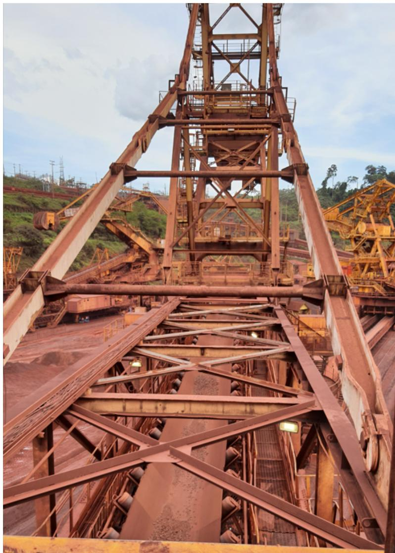
Figura 5.30: Correia da Lança da RP152K01. Fonte: KLIPPEL, 2020.
