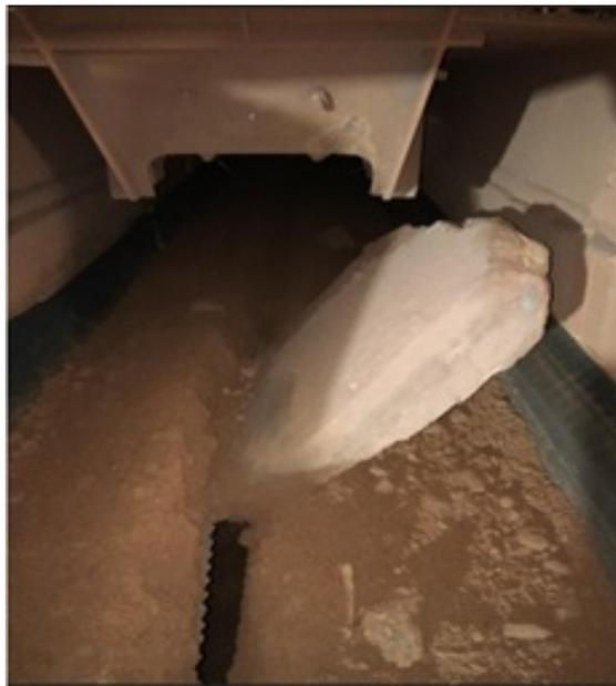
Figura 1.3: Correia rasgada por mataco lamelar. Fonte: KLIPPEL, 2019.
