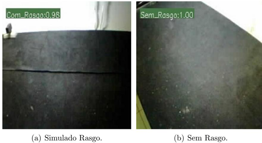
Figura 5.4: Imagens de Validação Classificadas pelo Modelo no aXeLeRate. Fonte: KLIPPEL, 2020.
