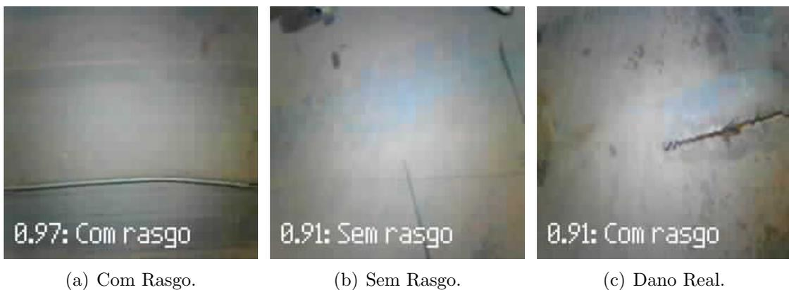
Figura 5.10: Imagens Estáticas Classificadas pela KPU do SiPEED. Fonte: KLIPPEL, 2020.
