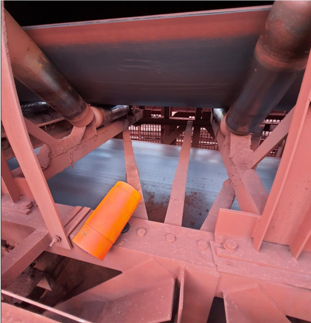
Figura 5.22: Simulação de Rasgo na Correia com Risco no Tapete. Fonte: KLIPPEL, 2020.
