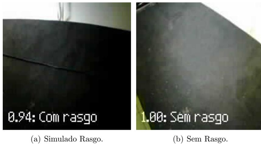
Figura 5.5: Imagens de Validação Classificadas pelo Modelo na KPU SiPEED. Fonte: KLIPPEL, 2020.
