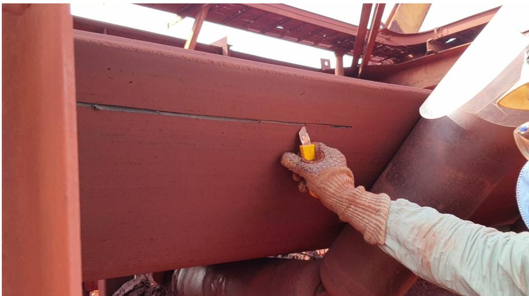
Figura 4.6: Simulação de Rasgo no Tapete da Correia. Fonte: KLIPPEL, 2020.
