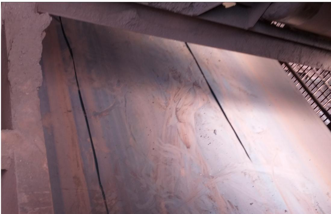
Figura 5.12: Conjunto de Rasgos Simulados na Correia. Fonte: KLIPPEL, 2020.
