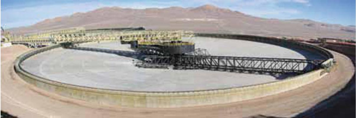
Figura 3.2: Espessador convencional de 125 metros de diâmetro.
