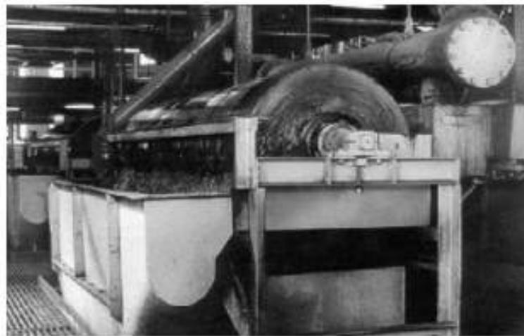
Figura 2.6: Separador magnético a úmido de baixa intensidade por tambor.
