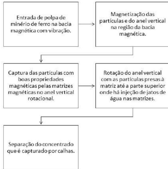
Figura 2.12: Fluxograma de funcionamento de um VPHGMS.
