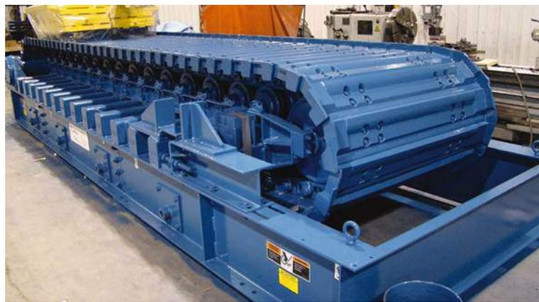
Figura 3.6: Alimentador de sapatas.
