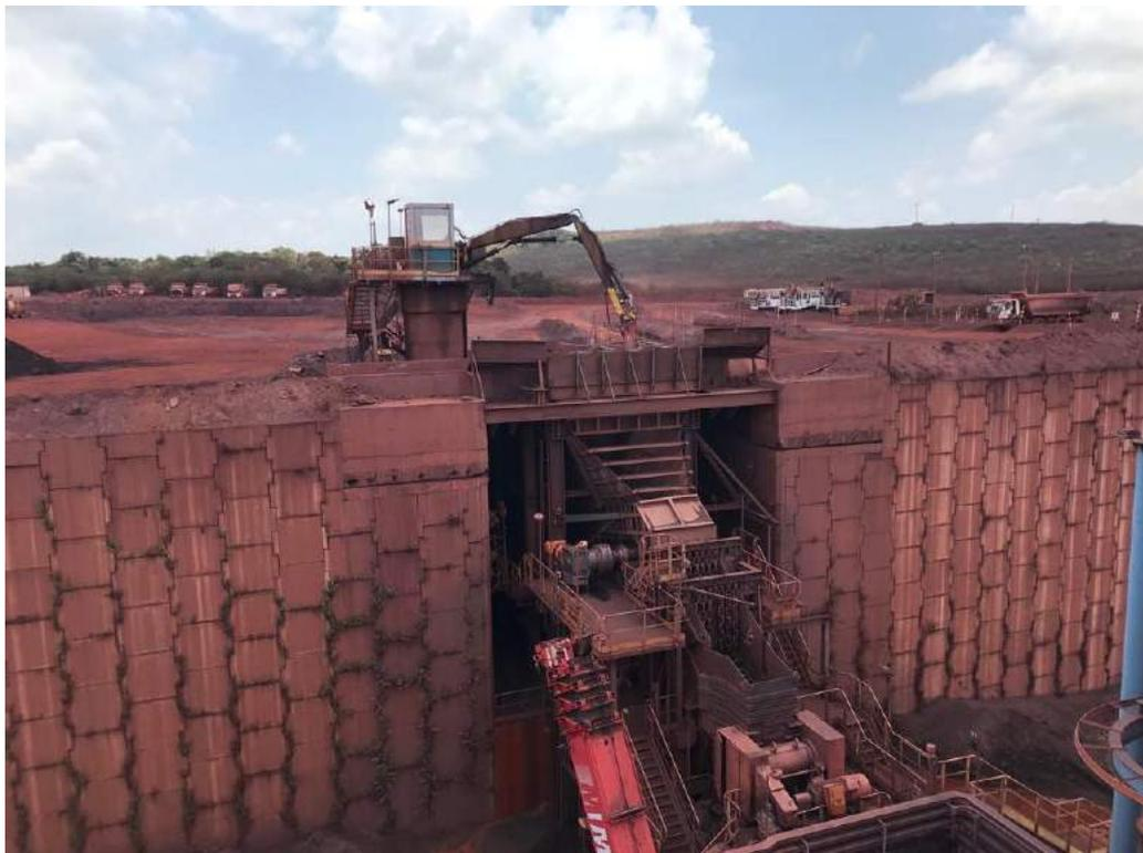
Figura 3.8: Alimentação primária da mina de Serra Leste.
