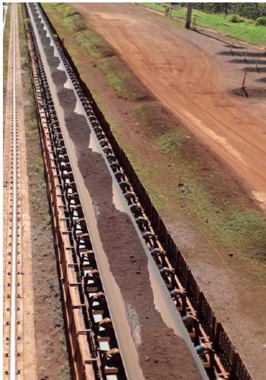
Figura 3.5: Correia transportadora com grande variabilidade no fluxo de material.
