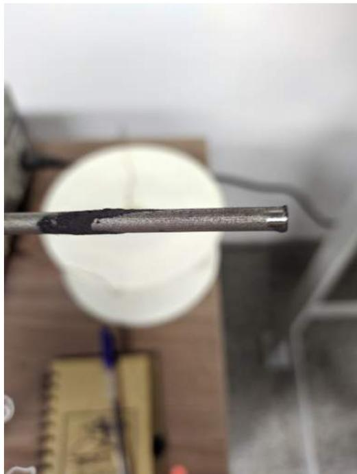
Figura 2.25: Pino com minério após a desmagnetização.
