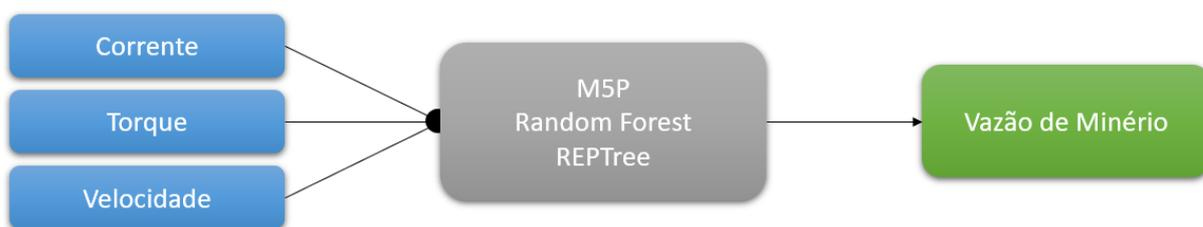
Figura 3.1: Modelos dos Sensores Virtuais Desenvolvidos. Fonte: O autor.
