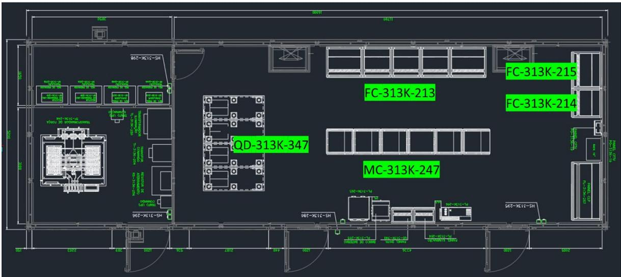
Figura 3-10: Planta baixa da sala elétrica da EP-313K-06 em Autocad 2D.
