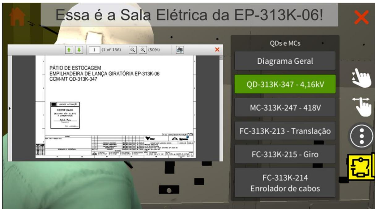
Figura 3-18: Menu dos diagramas unifilares.
