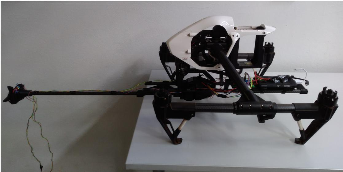
Figura 4.36: Manipulador montado vista lateral.
