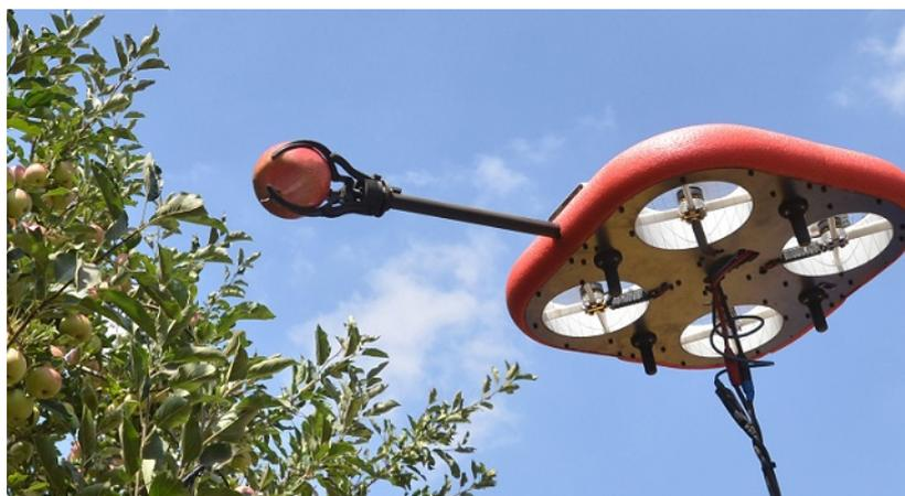
Figura 3.26: Drone coletor de maçãs, projetado pela startup Tevel (Israel). Fonte: (TEVEL, 2021).
