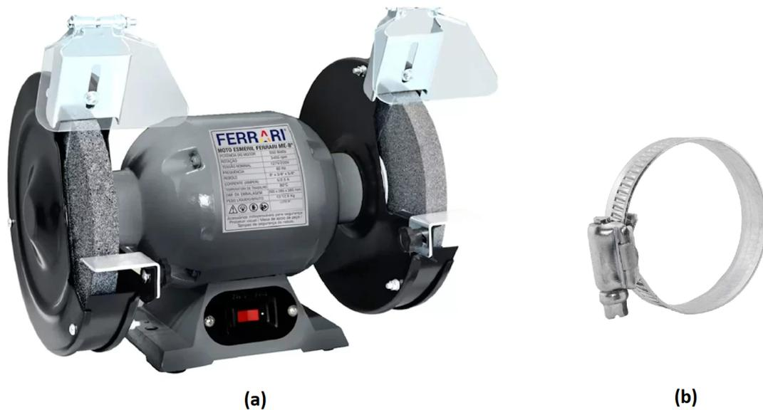
Figura 4.5: Foto do esmeril (a) utilizado para o experimento, e a abraçadeira (b) usada para o desbalanceamento.
