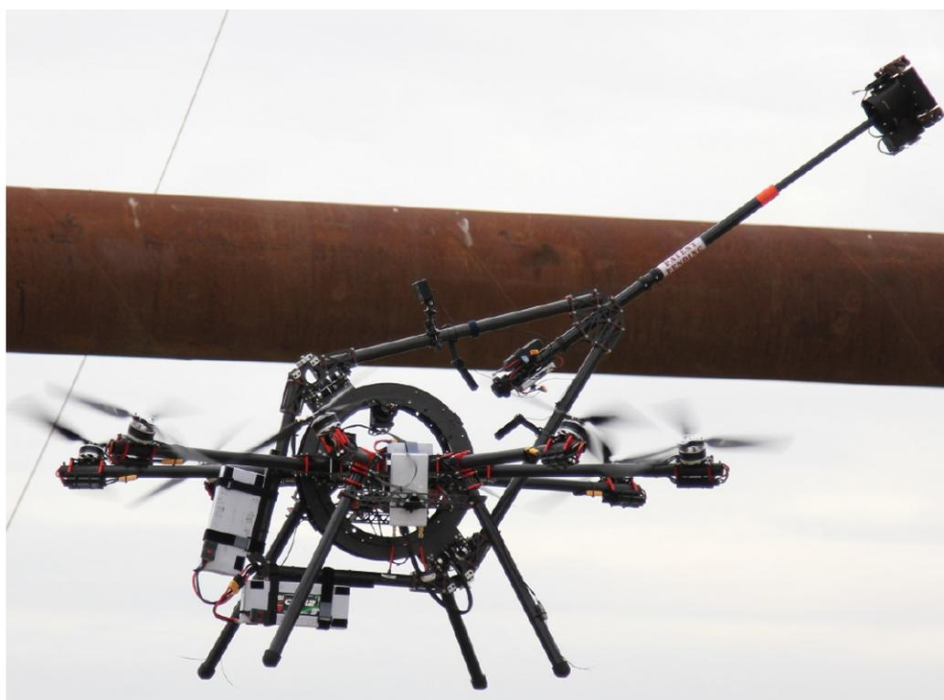
Figura 3.22: Drone AeroX de inspeção projetado pela CATEC. Fonte: (TRUJILLO, M.Á. *et al.*, 2019).
