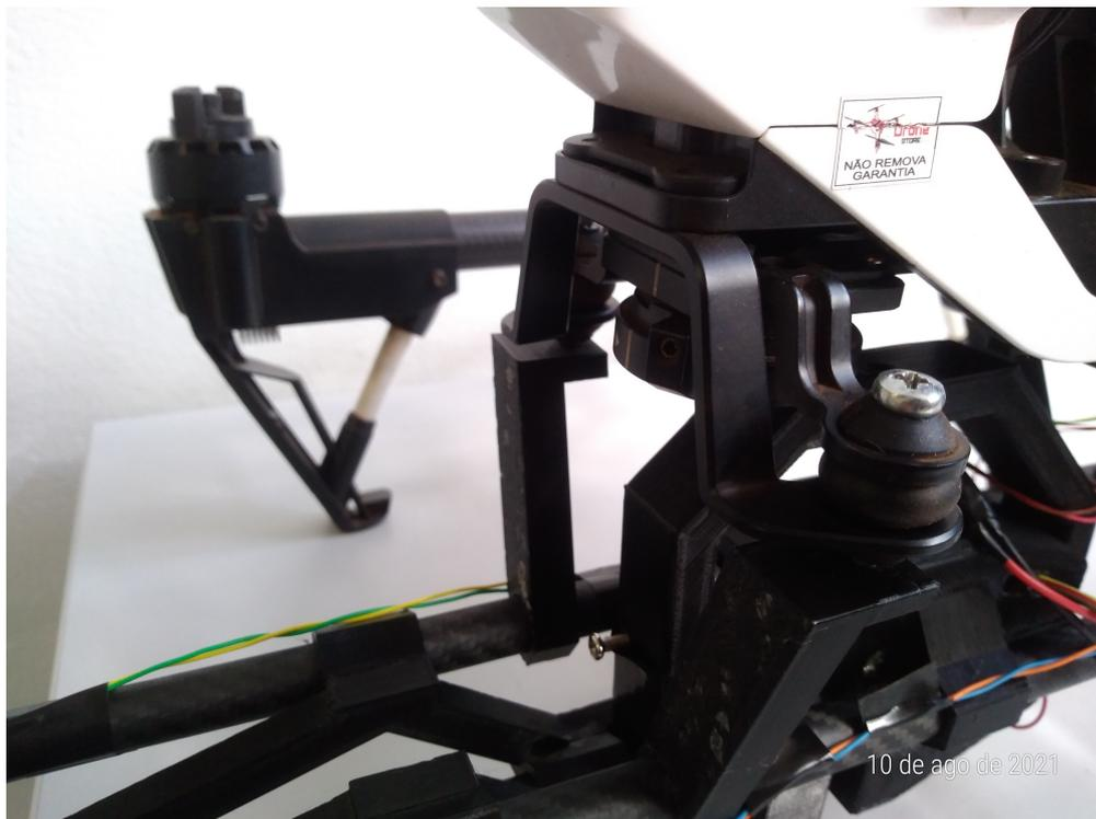
Figura 4.37: Detalhe do encaixe do manipulador no Inspire.
