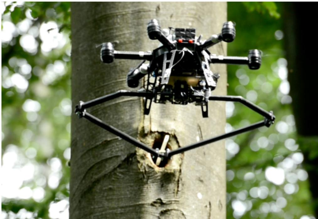
Figura 3.24: Drone utilizado para inspeção em árvores. Fonte: (ROBOHUB, 2020).
