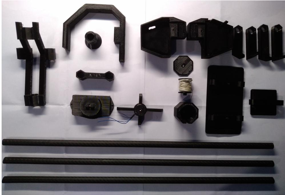
Figura 4.28: Peças impressas e tubos de fibra de carbono.
