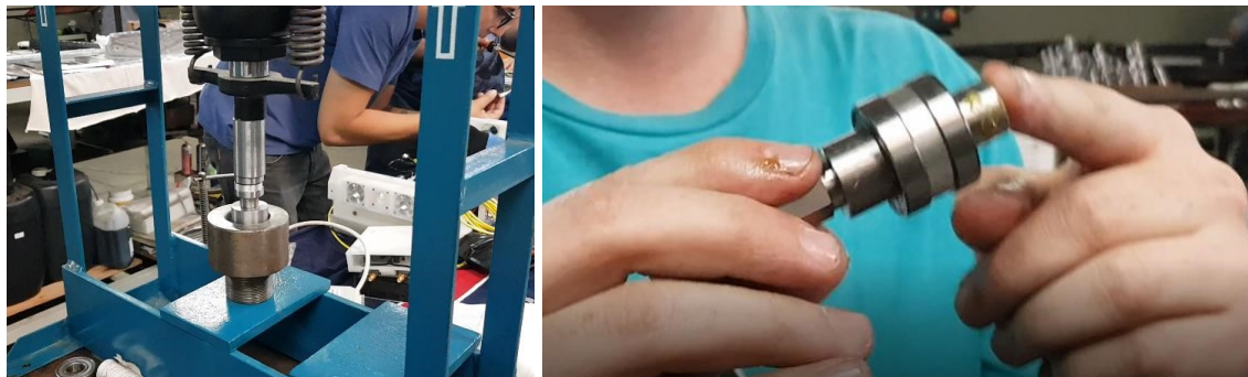
(a) Montagem dos rolamentos no eixo com auxílio da prensa hidráulica.
