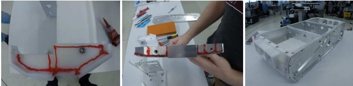
(a) Aplicação da junta líquida na lateral do compartimento central.
