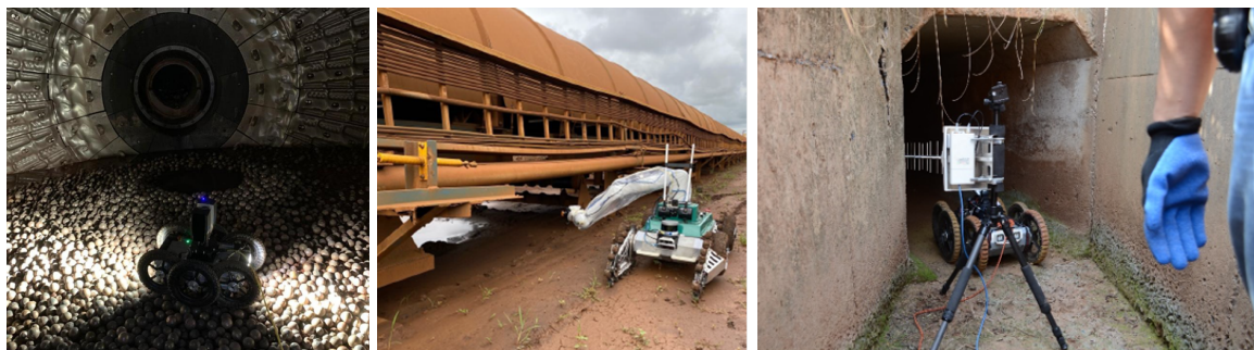
(a) Inspeção de moinhos de bola com o EspeleoRobô.
