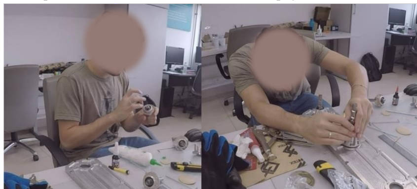
(c) Montagem da junta e do mancal na placa lateral externa.
