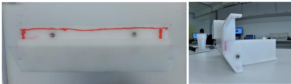
(a) Modo de aplicação da junta líquida no componente.
