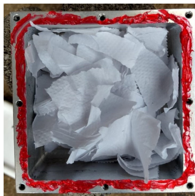
Figura 2.6: Aplicação de junta líquida para teste de imersão.
