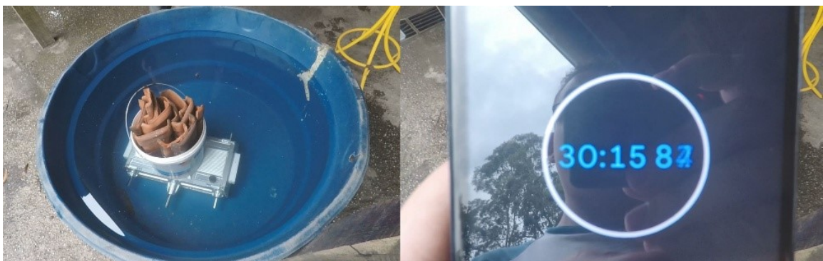
Figura 2.18: Robô submerso no teste de vedação e cronômetro indicando o tempo de permanência debaixo d'água.
