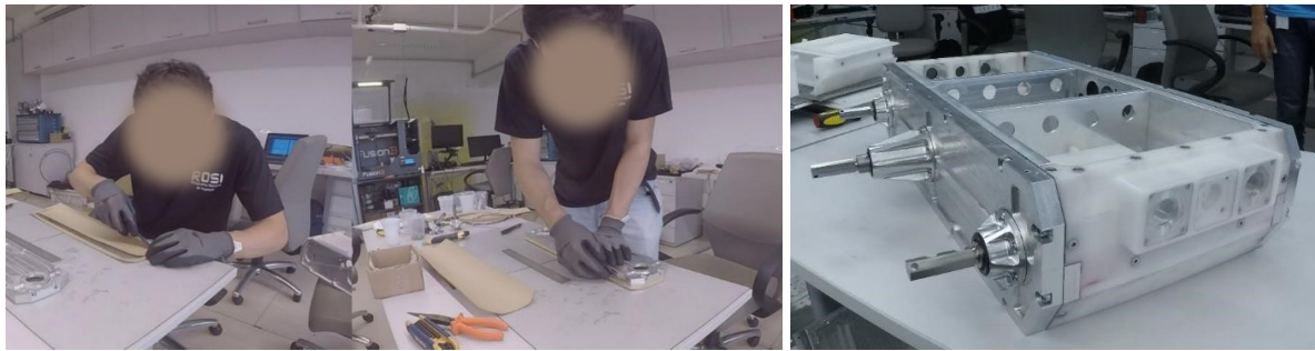
(a) Confeção das juntas em papelão hidráulico das placas laterais externas.
