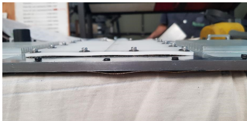
Figura 2.17: Deformação na tampa superior causada pela cortiça emborrachada. Fonte: O autor.
