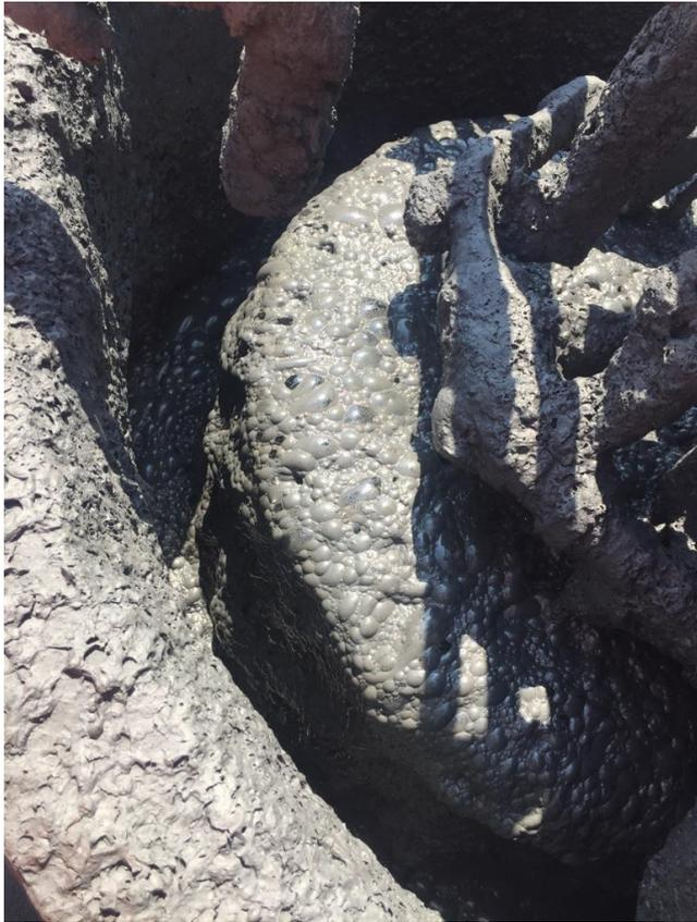
Figura 1. Espuma de flotação de minério de chumbo.
