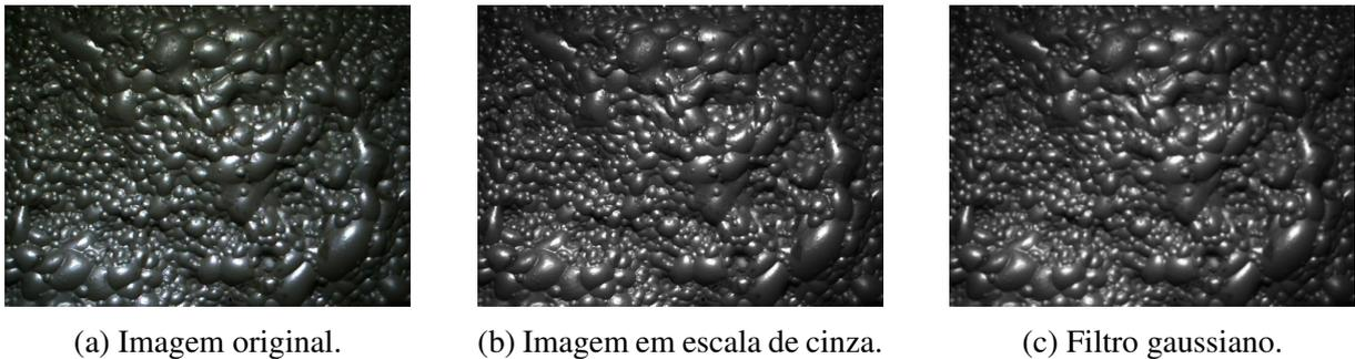
Figura 3.6: Processamento inicial das imagens para aplicação do algoritmo *Watershed*.
