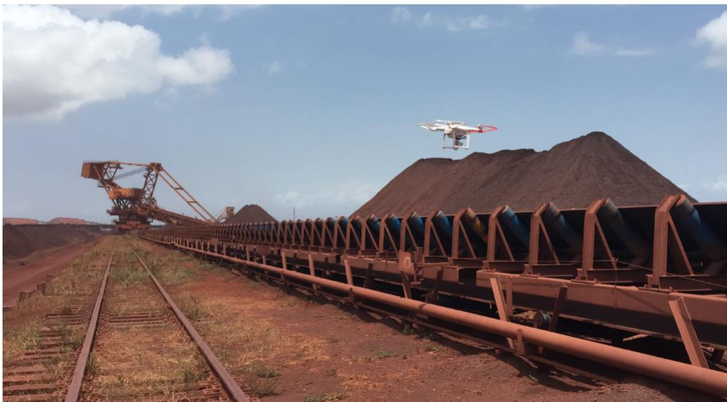
Figura 2.6: Coleta de dados de um TC usando drone.
