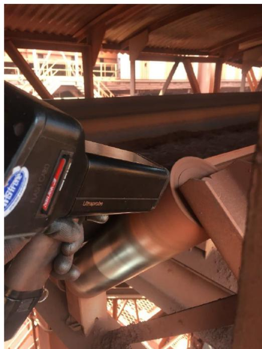
Figura 2.11: Gravação de ultrassom de um rolo em um transportador.
