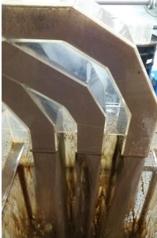
Figura 6 – Fluxos da polpa do rejeito de manganês provenientes das regiões inferior, central e superior do tubo
