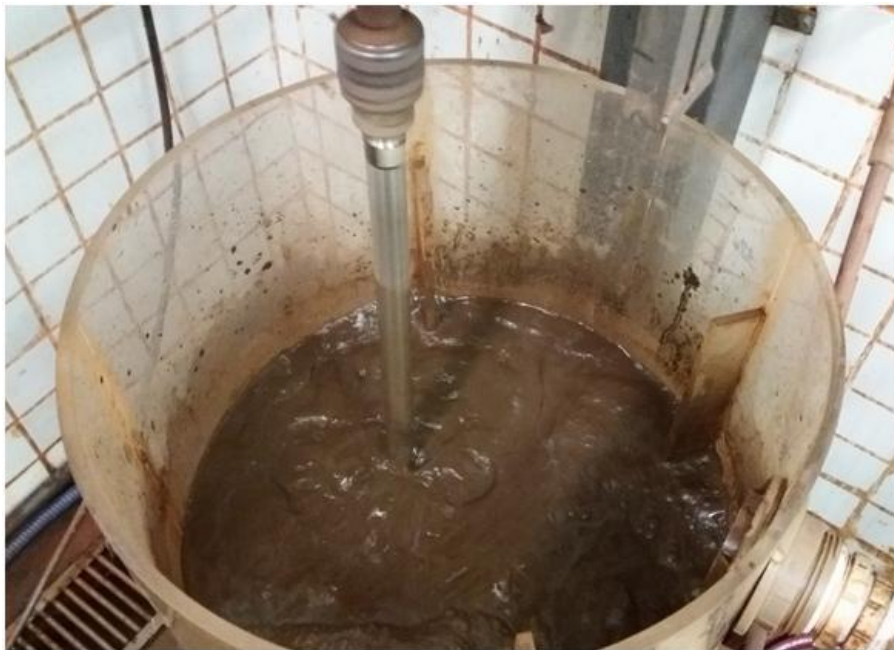
Figura 5 – Homogeneização da polpa mineral em tanque de mistura
