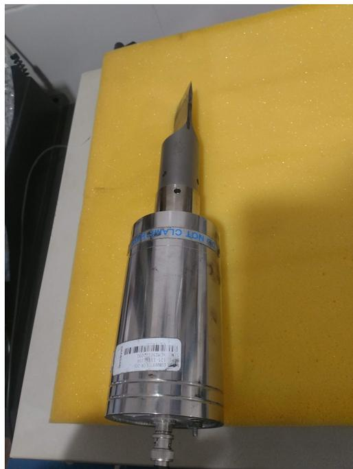
Figura 4.13: Usinagem da correia por ultrassom.
