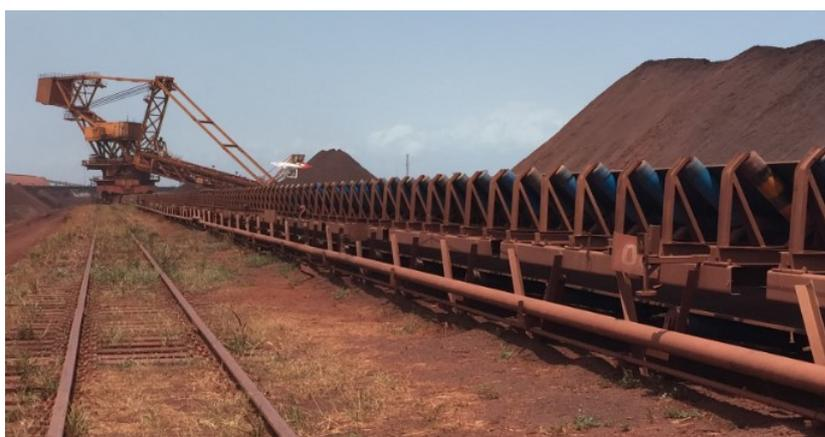
Figura 1.1: Transportador de correias na mineração.
