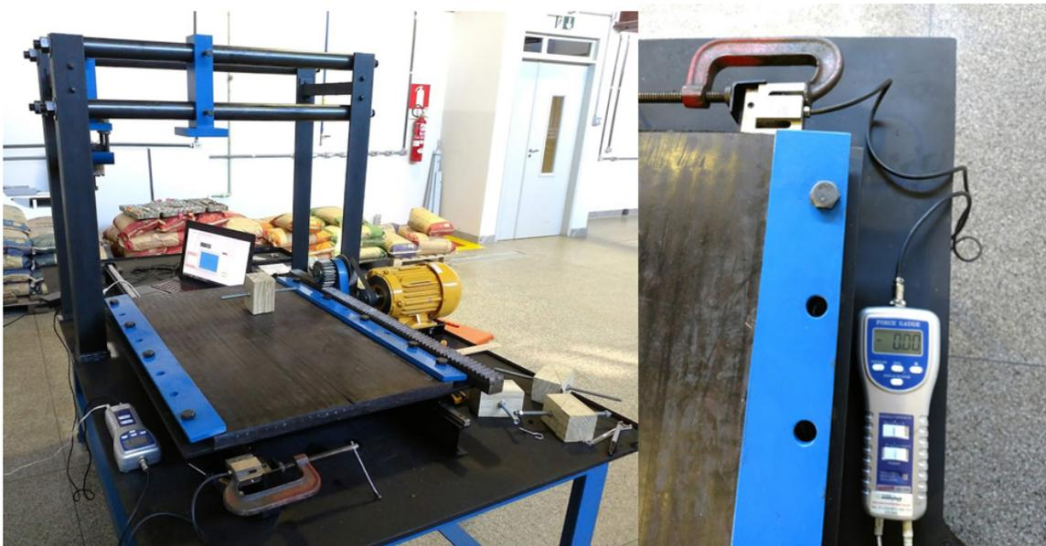
Figura 4.3: Aparato para cortes com lâmina.
