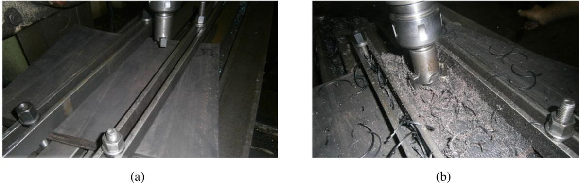
Figura 2.17: Correia transportadora usinada com fresa.
