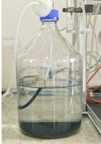
Figura 24. Frasco lavador que foi acoplado ao biorreator para o ensaio com AMD natural retirada de uma mina de cobre da região Amazônica. No fundo do frasco um precipitado de cor azul escura pode ser observado.
