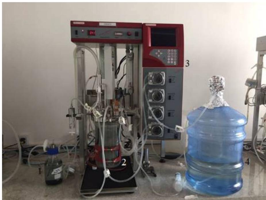
Figura 7. Biorreator utilizado no experimento. 1: Frasco lavador; 2: Biorreator; 3: Unidade FerMac. 4: AMD de alimentação.
