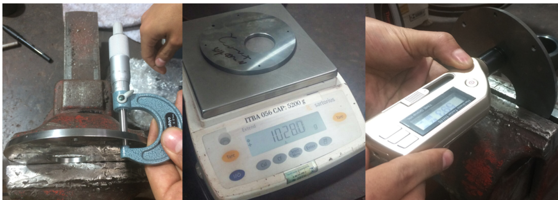
Figura 2.6: Verificação dos corpos moedores utilizados nos Centaurus
