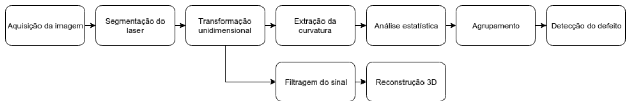
Figura 4.2: Fluxograma do método proposta para a detecção de defeitos na correia
