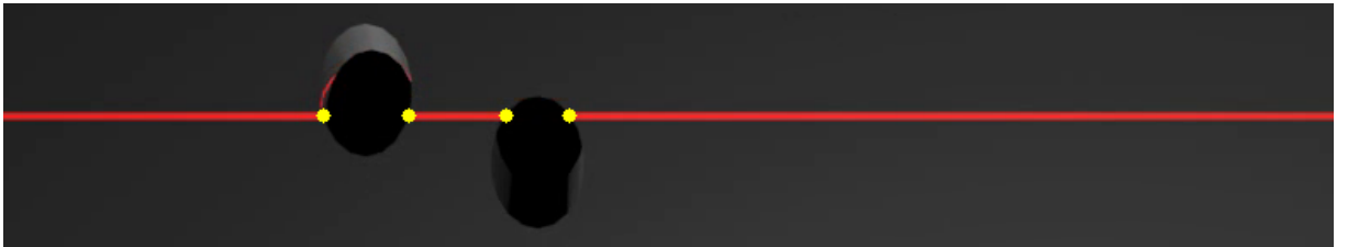
Figura 5.5: Pontos de defeitos identificados na correia
