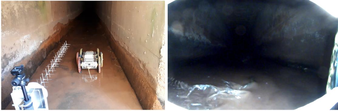
Figura 6.6: Inspeção na galeria da Barragem de Taquaras. À esquerda, EspeleoRobô iniciando o teste. À direita, momento em que um peixe foi flagrado circundando o robô.
