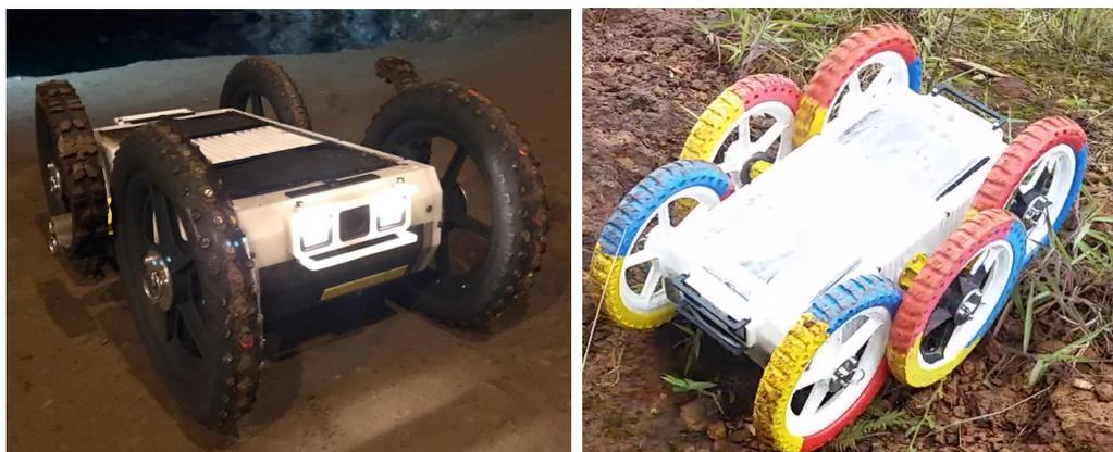
Figura 6.1: Primeiros testes realizados com o EspeleoRobô, sendo o teste na Minas da Passagem em Mariana-MG (à esquerda) e no campus da UFOP em Ouro Preto-MG (à direita).
