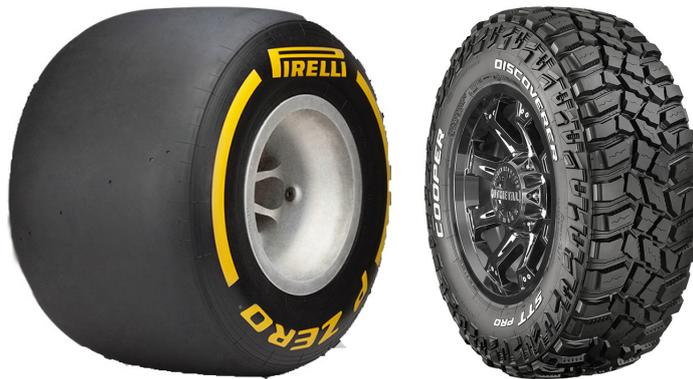
Figura 4.6: Exemplo de diferentes perfis de pneu: liso (à esquerda) e rugoso (à direita). (Arquivo público da internet).
