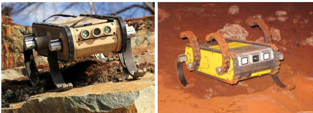
Figura 1.3: Comparação entre as morfologias do RHex (à esquerda) e o EspeleoRobô (à direita).
