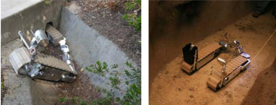
Figura 1.8: Robô CTER configurado para entrar no ambiente confinado através de um pequeno orifício (à esquerda) e para efetuar a inspeção do mesmo (à direita) (LARSON *et al.*,2014).
