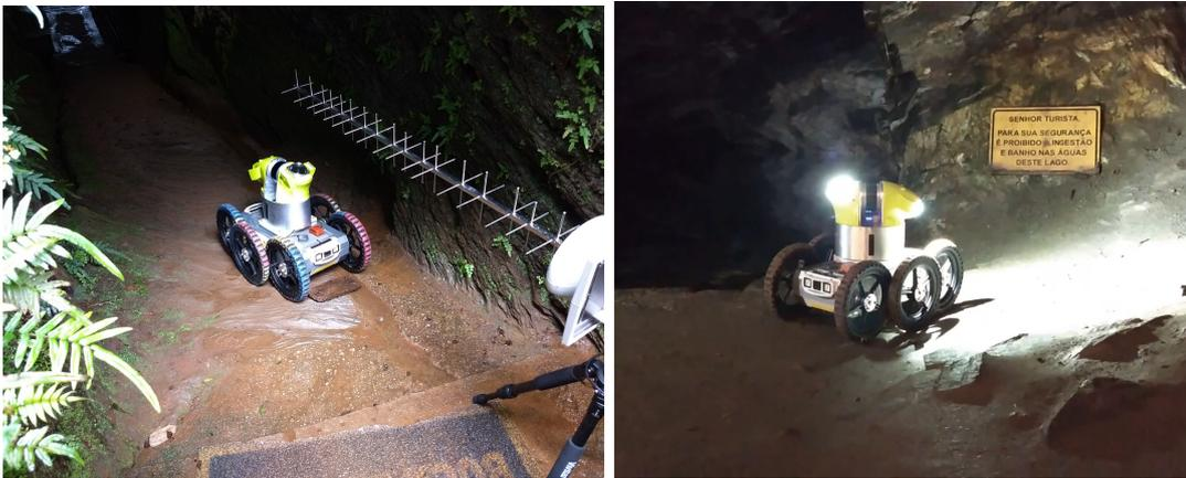
Figura 6.8: Testes realizados do EspeleoRobô com a torre de mapeamento acoplada.
