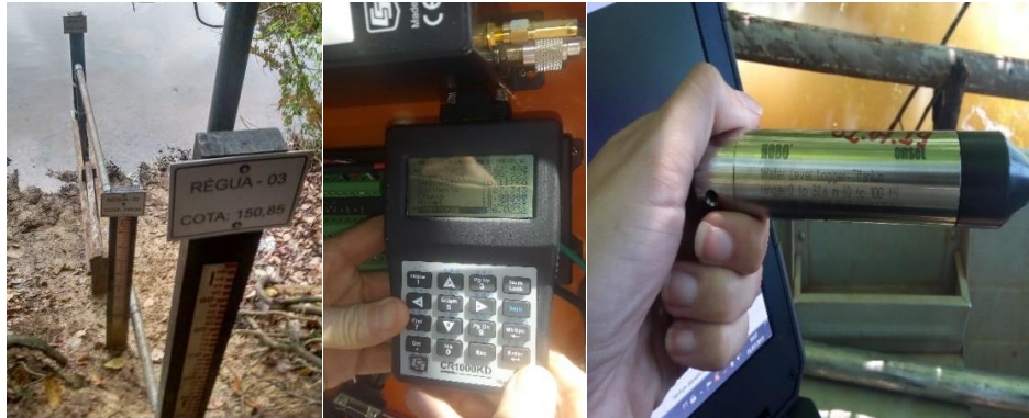
Figura 3 – Modelo de réguas limnimétricas instaladas, o leitor do data logger das estações que mostra o nível do rio e outras variáveis, e a sonda de nível HOBOT.
