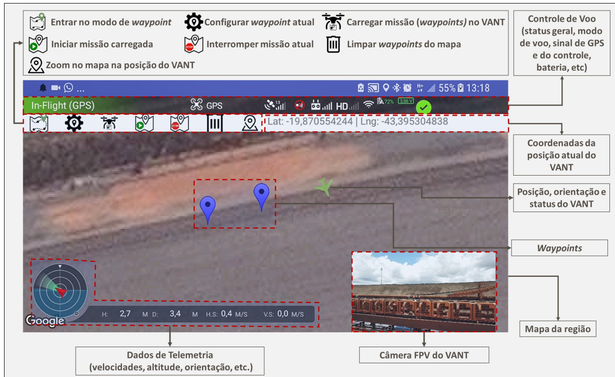
Figura 60 – Visão geral da aplicação Android para controle do portador. Fonte: autor
