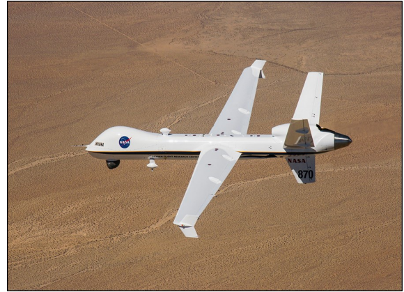
(b) Ikhana, adaptação pela NASA do Predator para uso científico. Fonte: CONNER, 2015
