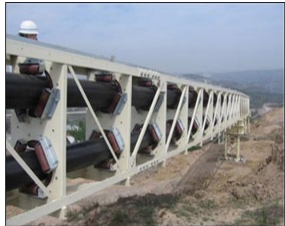
(b) Exemplo em campo de um TC do tipo Tubular. Fonte: ZOOMLINE, 2017
