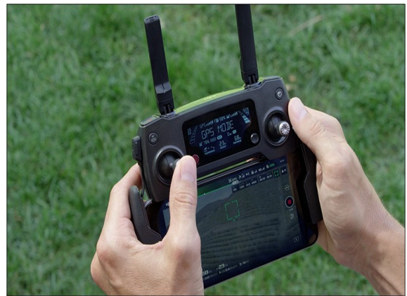
(b) Controle físico e aplicativo específico formam o GCS do Mavic Pro. Fonte: DJI, 2017c
