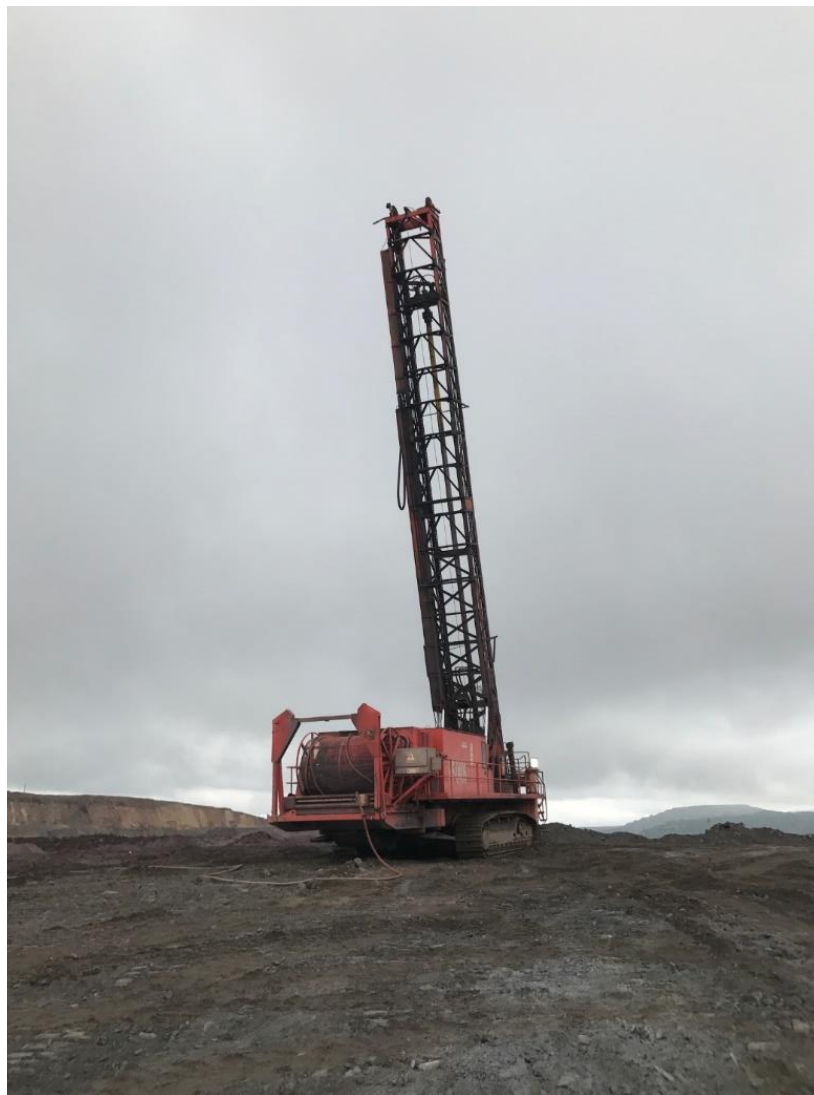
Figura 17: Perfuratriz com haste na posição de perfuração.
