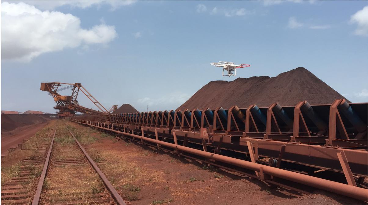
Figura 21 – Voo realizado pelo RPA da DJI Phantom 3 para adquirir imagens dos rolos do transportador de correia.
