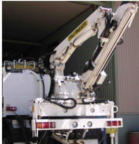
Figura 6 – Caminhão de carregamento de explosivos com manipulador mecânico.
