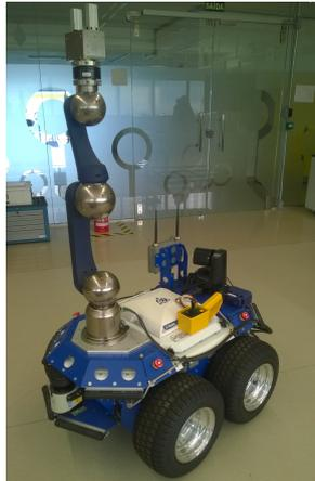
Figura 3: Robô usado como base da implementação: ‘Seekur Jr’, equipado com braço manipulador ‘Schunk Powerball’.
