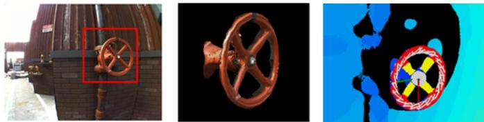
Figura 12 – Sistema de percepção do DRC-HUBO+: Detecção e localização de uma válvula através do processamento de imagens com informações de profundidade obtidas por um laser planar.
