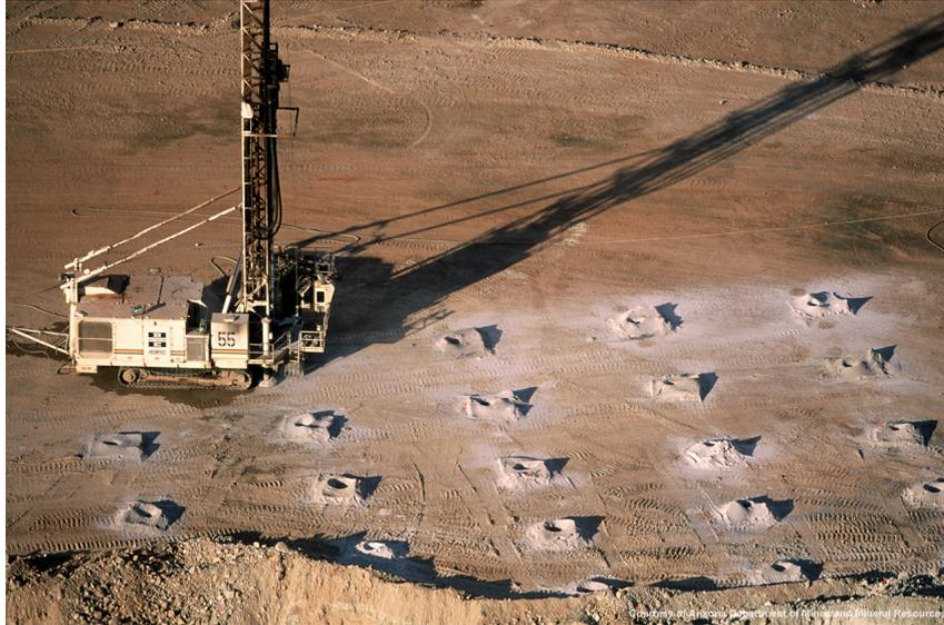
Figura 1 – Perfuração de rocha para carregamento de explosivos em mina a céu aberto.
