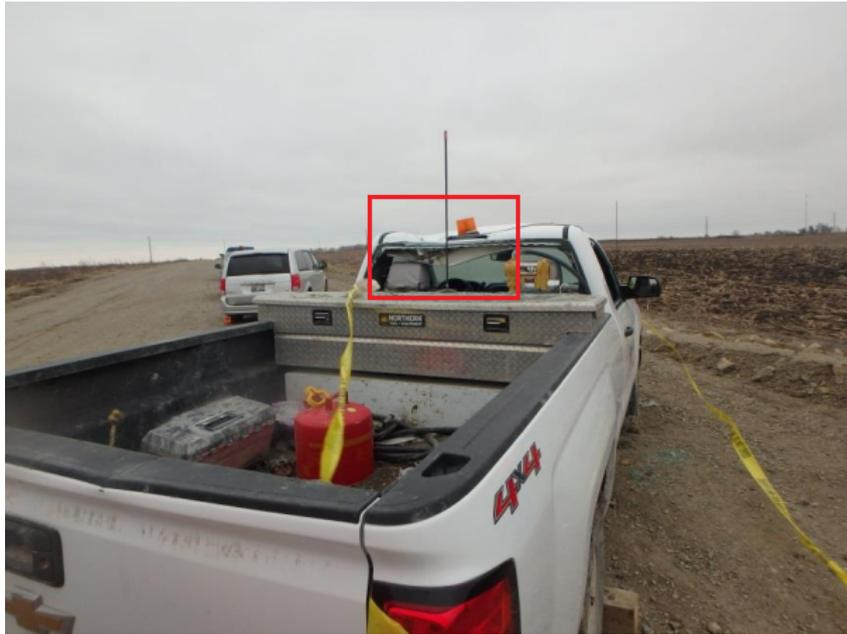
Figura 4 – Caminhonete atingida por fragmento de rocha em operação com explosivos: o fragmento penetrou no teto do veículo e atingiu a vítima.
