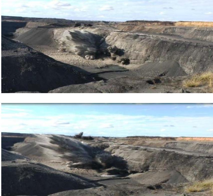
Figura 2 – Arremesso de fragmentos de rocha provocado por desmonte com explosivos.
