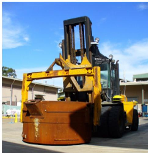
Figura 5 – Hot Metal Carrier manipulando um cadinho de alumínio.
