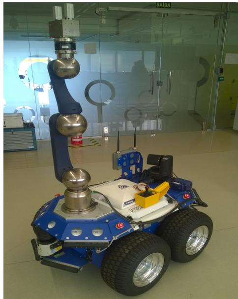
Figura 19 – Robô usado como base da implementação: Seekur Jr, equipado com braço manipulador *Schunk Powerball*.
