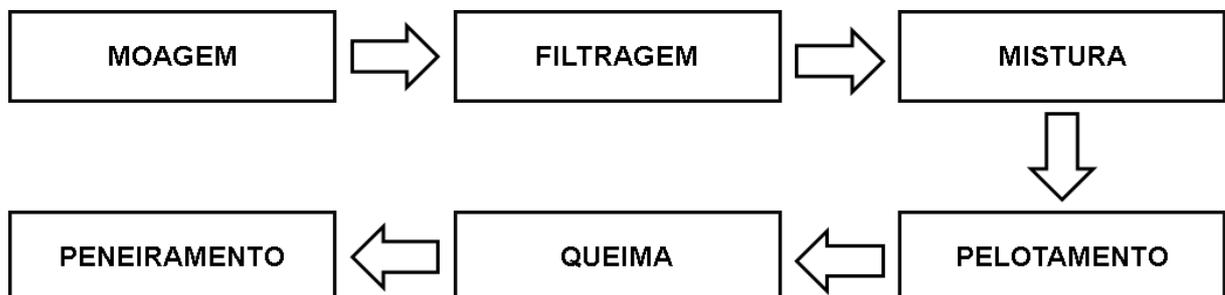
Figura 1: Processo de Pelotização da Mina de Fábrica
