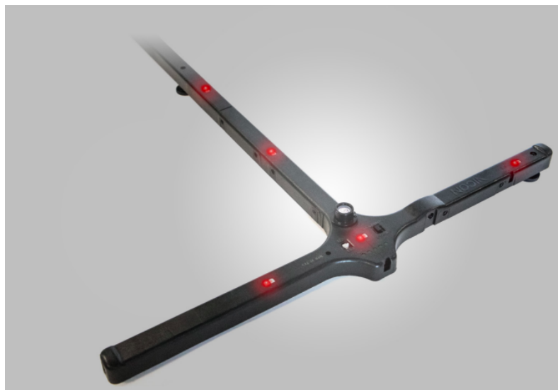
Figura 4.1: Objeto utilizado para calibrar câmeras Vicon e definir volume de rastreamento.
