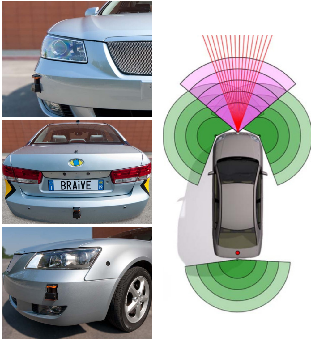
Figura 2.12: Posicionamento dos sensores Hokuyo UTM-30LX acoplados no protótipo BRAiVE e faixa de detecção (em verde) (BROGGI et al. , 2013).
