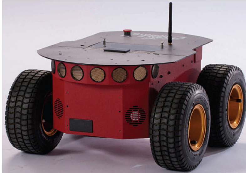
Figura 2.2: Plataforma robótica móvel Pioneer 3-AT (BASACA-PRECIADO et al. , 2014)
