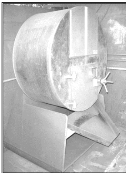
Figura 4.6: Tambor utilizado em ensaios de Índice de Tamboramento (PASSOS, 2016)
