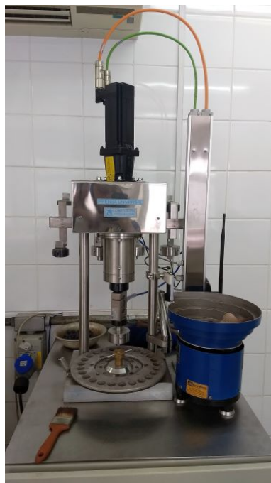
Figura 4.5: Prensa eletrônica de bancada para ensaios de resistência de compressão a frio utilizada no CTF (Vale S.A).
