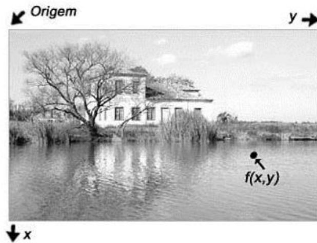
Figura 9: Convenção dos eixos para representação de imagens digitais (GONZALES et al., 2007).
