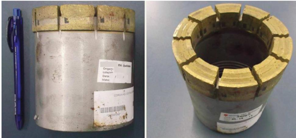
Figura 2.2: Coroa de diamantes. (Coroa HQ-2 extra lateral S-2, Geosol). Fonte: (CARVALHO,2014)
