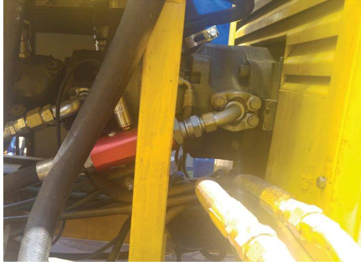
Figura 3.6: Sensor de vazão na saída da bomba principal.
