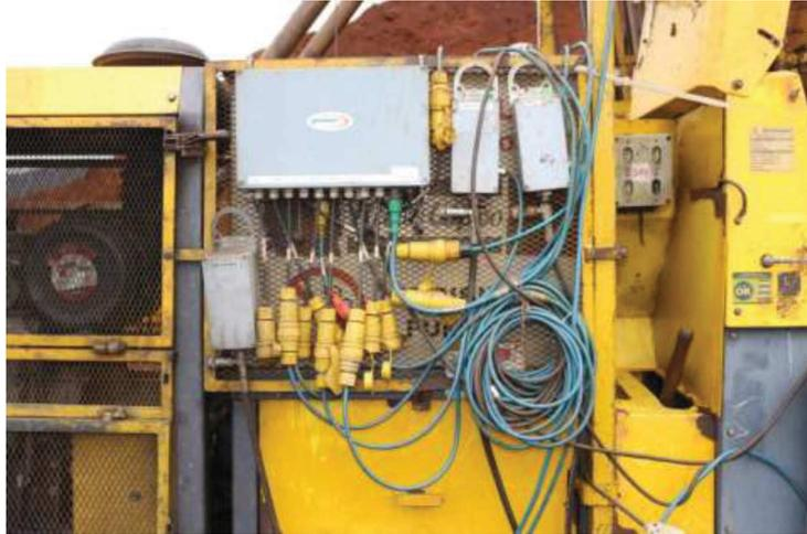
Figura 2.9: Montagem do EDR na lateral de uma sonda CS14. Fonte: (FILHO,2015)
