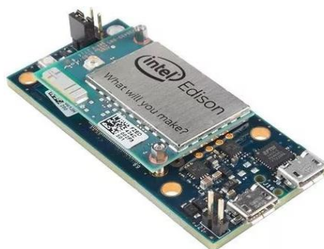
Figura 2. Placa Intel Edison utilizada nos testes com Wi-Fi e Bluetooth
