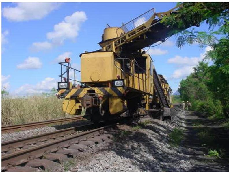
**Figura 7:** Máquina desguarnecedora da EFVM
