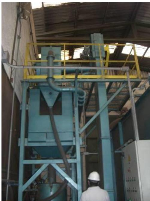
**Figura 10:** Filtro de manga da cabine de jateamento de granalha
