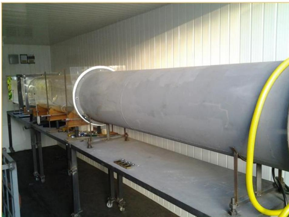
**Figura 24:** Túnel de Vento
