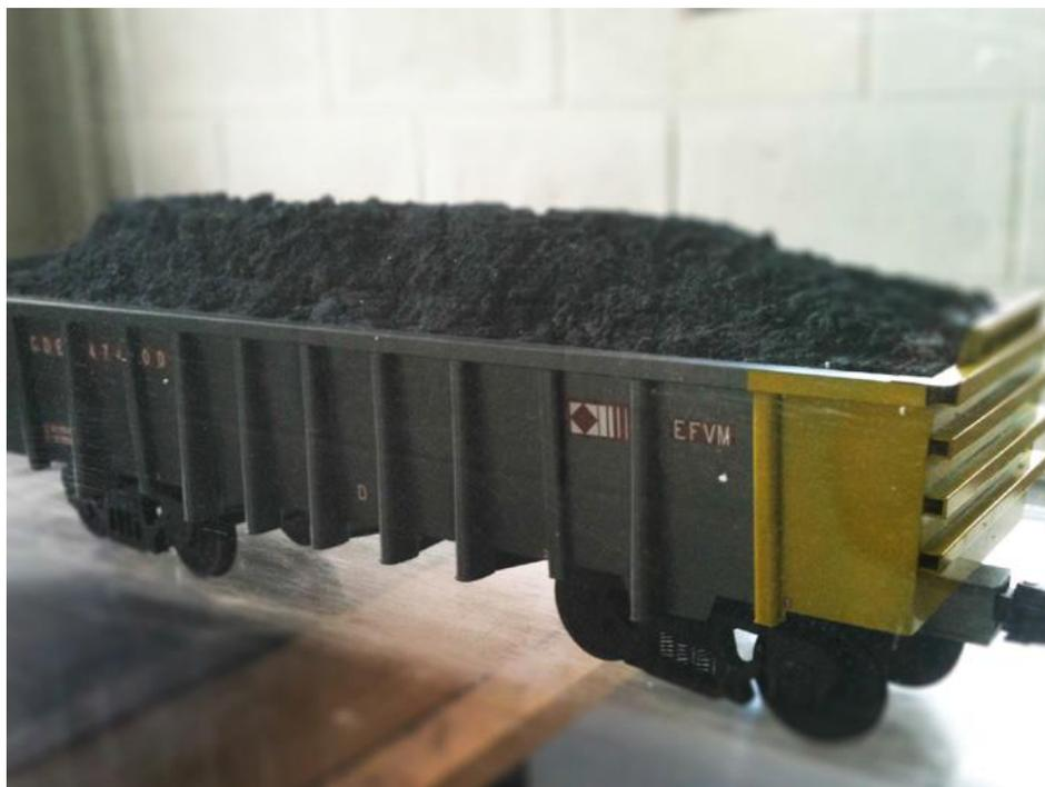
**Figura 23:** Modelo de vagão utilizado no experimento (43,0 x 11,5 x 10,0 cm)
