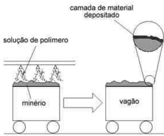
**Figura 15:** Esquema do sistema de aspersão
