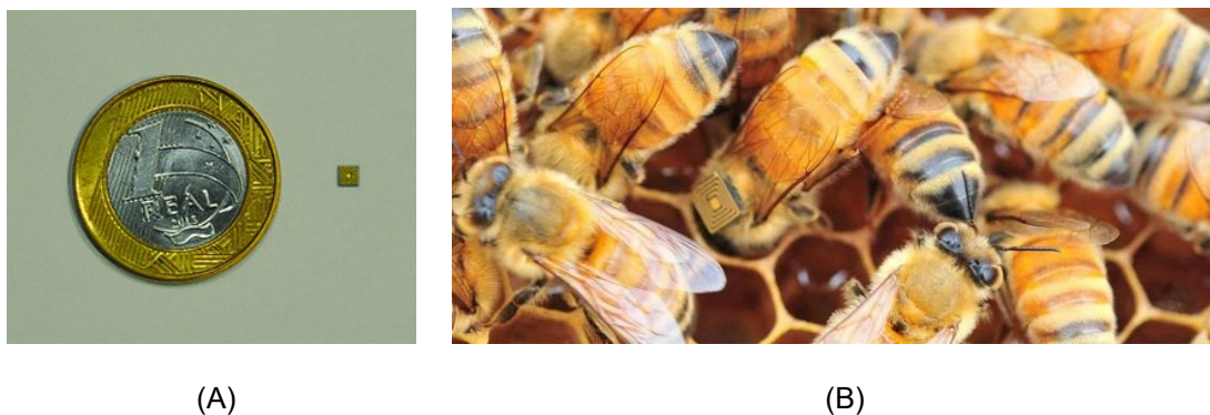
Figura 4: Etiquetas eletrônicas usadas nos experimentos. (A) Comparação de tamanho entre uma etiqueta e uma moeda de um real. (B) Etiqueta instalada no tórax de uma abelha.
