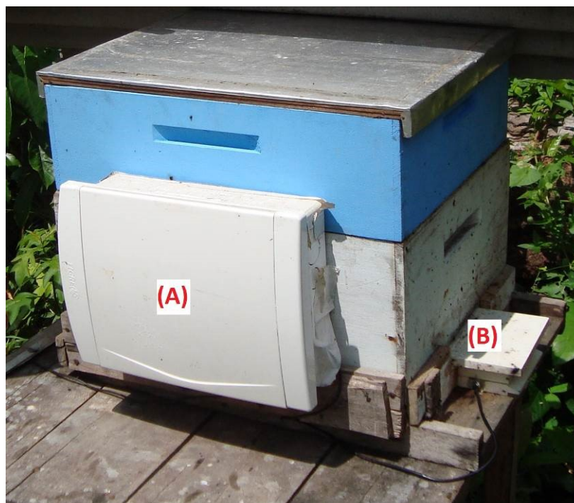
Figura 3: Localização do Mini-PC e Leitor instalados na Colmeia. (A) local onde fica armazenado o Mini-PC, (B) local onde fica armazenado o Leitor.
