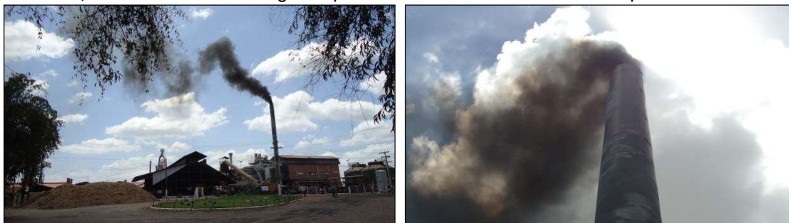
Figuras 21 a, b – Emissão de MP e gases para a atmosfera durante teste de queima com dormentes.
