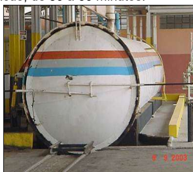
(b) Autoclave dimensões: H=2,50m x P=5,00m.
