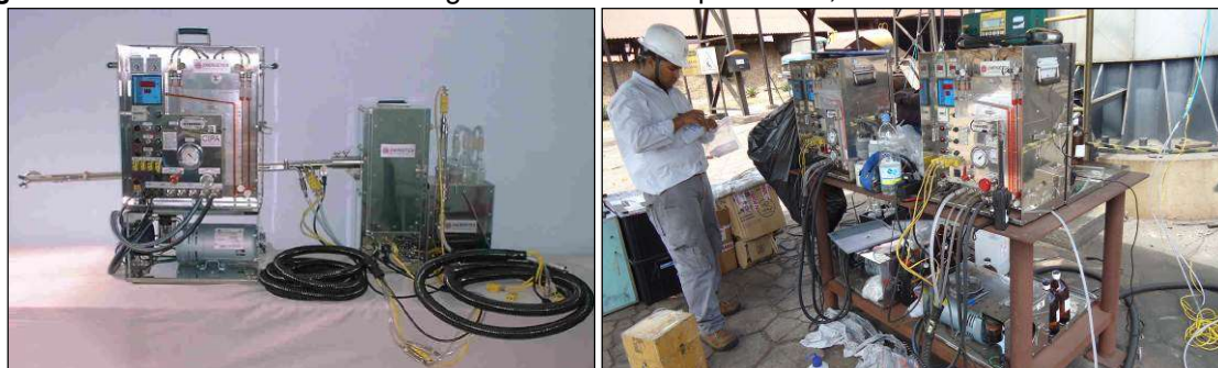
Figura 15 - Foto do trem de amostragem utilizado no experimento, de acordo com o método 5 EPA.
