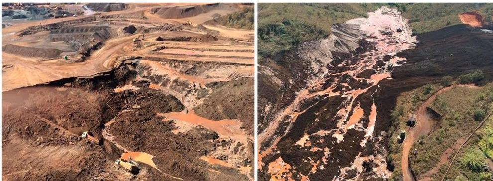
Figura 3: Impacto causado pela ruptura da barragem B1. Observam-se grandes áreas afetadas e maquinários cobertos pelo rejeito. (Fonte: G1 MG, 2014).
