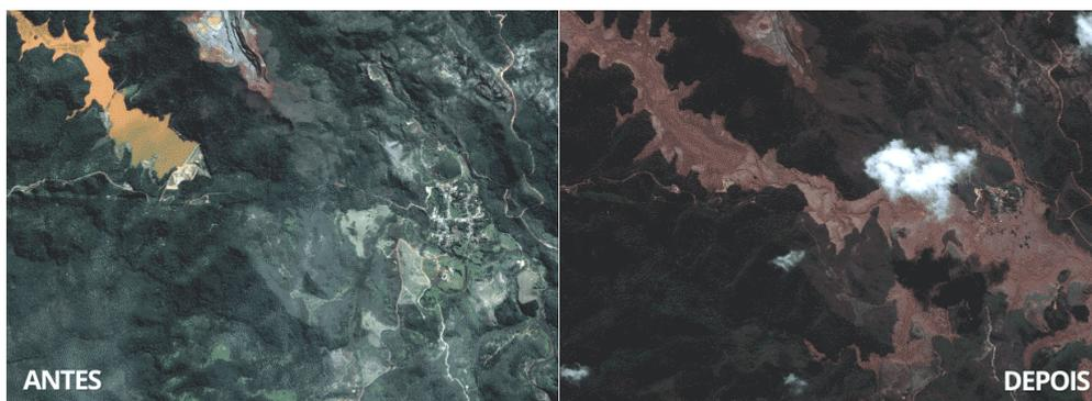
Figura 4: Impacto causado pela ruptura da barragem do Fundão. (Fonte: D'AGOSTINO, 2015)
