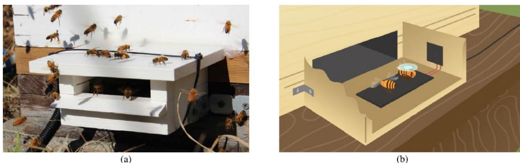
Figura 4 – O experimento das abelhas em Geeveston, Tasmânia, Austrália: (a) entrada da colmeia; (b) leitor de RFID instalado embaixo da entrada que detecta a passagem de abelhas marcadas.
